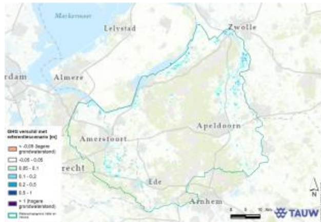
2 - Potentiele verhoging van de drainagebasis (GHG) bij peilopzet van 25 cm van de TOP10 watergangen.
